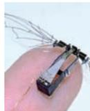
Quelli a sei (o più) "zampe" servono per attraversare terreni e stretti passaggi; quelli a due (a più) "ali" per volare, magari senza essere notati. Non più grandi di un'unghia, sono progettati per essere impiegati in gran numero in caso di terremoti o altre calamità, oppure per il monitoraggio costante del territorio. Allo studio anche l'imitazione della natura non solo nelle forme, ma anche nelle finalità: per esempio per l'impollinazione.
